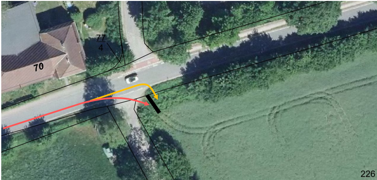
Abb. 28: Verhinderung regelwidrigen Abkürzens (rot = regelwidrige Fahrbeziehung, orange = beabsichtigte Fahrbeziehung)
