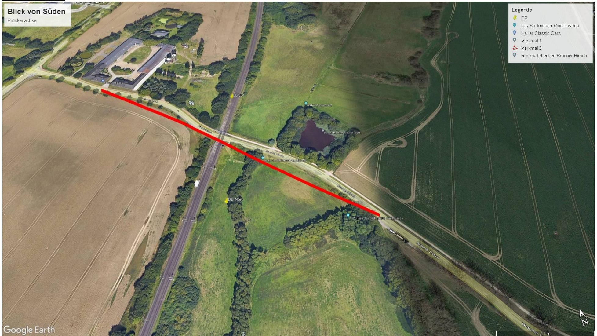
Laut einem Gutachten aus 2019 zur Südumfahrung ist statt bisher 8500 Kfz/24h nach dem Bau der Brücke mit 12.000 Kfz/24h zu rechnen. Die Stahlbrücke wird um ca. 6 m über den Gleisen liegen und den Schall aus dem Tal (quasi als Klangkörper) weiter verteilen.
